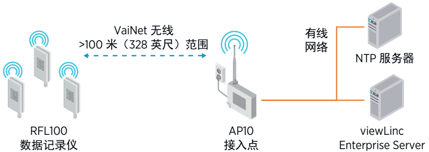
图 32 将 RFL100 连接到 viewLinc 监控系统
