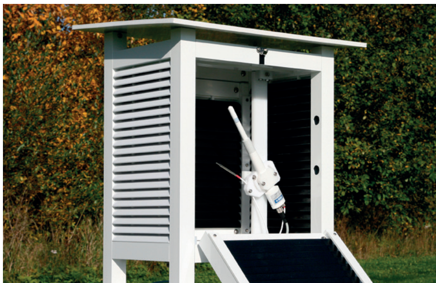
HMP155 z dodatkową sondą temperatury i opcjonalnym zestawem do montażu w klatce Stevensona.
