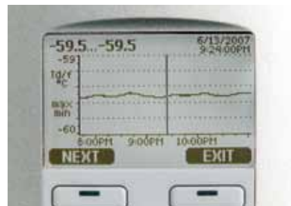
Wyświetlacz pokazuje trend pomiaru oraz ponad czteroletnią historię danych pomiarowych.
